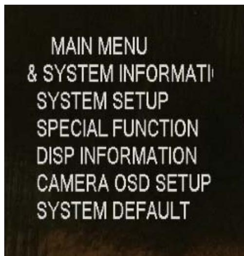
Durante la visione live della telecamera con il browser è possibile accedere a un menu di configurazione del modulo telecamera richiamando il **preset 95**
